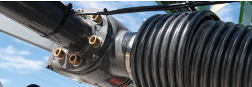
Szuper megbízható: a hajtáslánc 1000 Nm nyomatékra méretezett, így nagy növénymennyiségekkel nagy munkasebesség mellett is megbirkózik.
