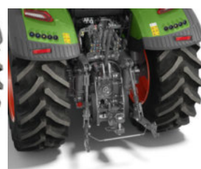
Hátsó emelőmű gyorscsatlakozóval és Rub blokkokkal (AU, Dél-Afrika, Kelet-Európa)
