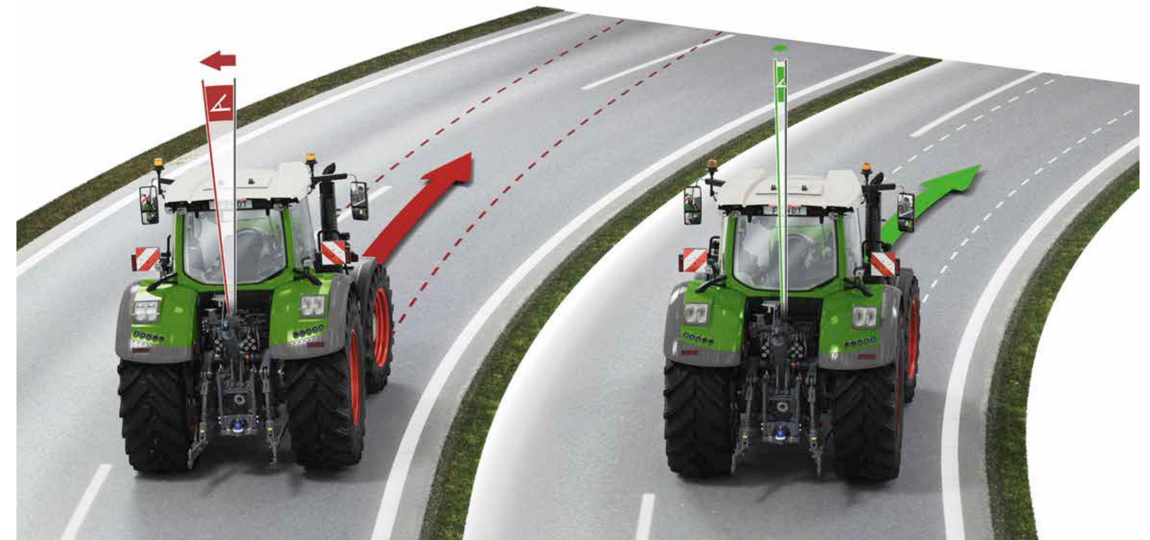
FSC nélkül A traktor letér a nyomvonalról
